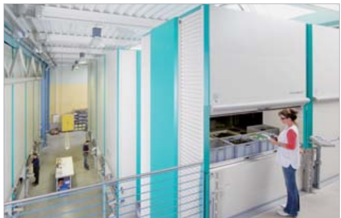
Afhængig af højden på Hänel Lean-Lifterne®, kan arbejdsåbningerne installeres på forskellige etager. Flere personer kan bruge Hänel Lean-Liften® samtidigt fra forskellige pladser og niveauer
