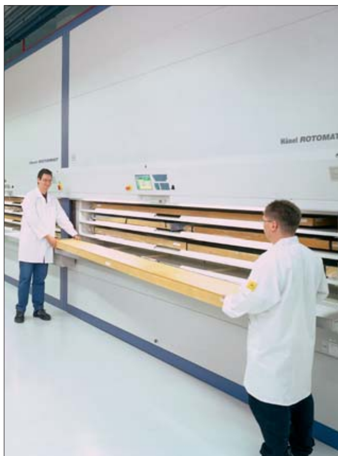
Sikker opbevaring af uhåndterlige dele i Rotomat ® industripaternostre
