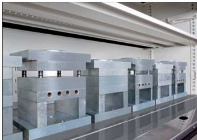
Værktøjsopbevaring i Rotomat ® industripaternostre
